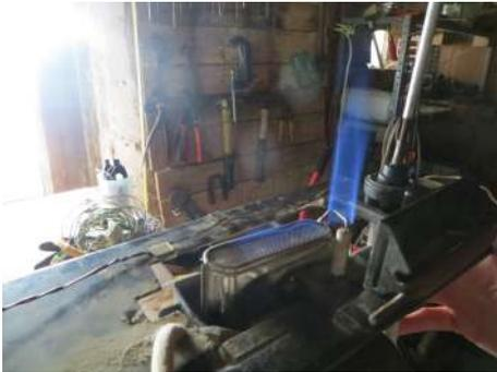
Brûleur de chauffage fonctionnant au biogaz
