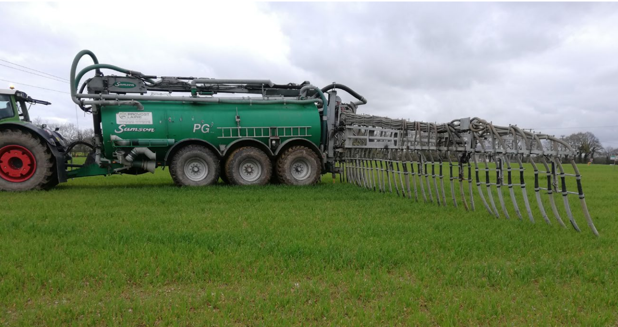
Épandage de digestat liquide au pendillard (Crédit : FRCUMA Ouest)
