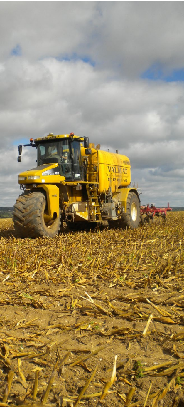
Épandage de digestat liquide avec automoteur et enfouisseur
